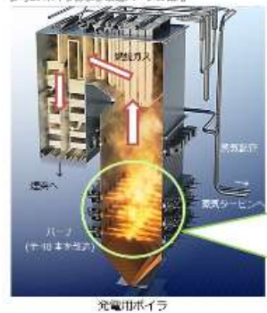
参考2: ボイラおよび改修バーナの概略
