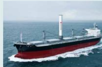
ローターセイル設置後の鉱硫船KORYU
