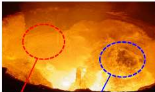
Hot spot (水冷パネル露出) Cold spot (未溶解スクラップ)
