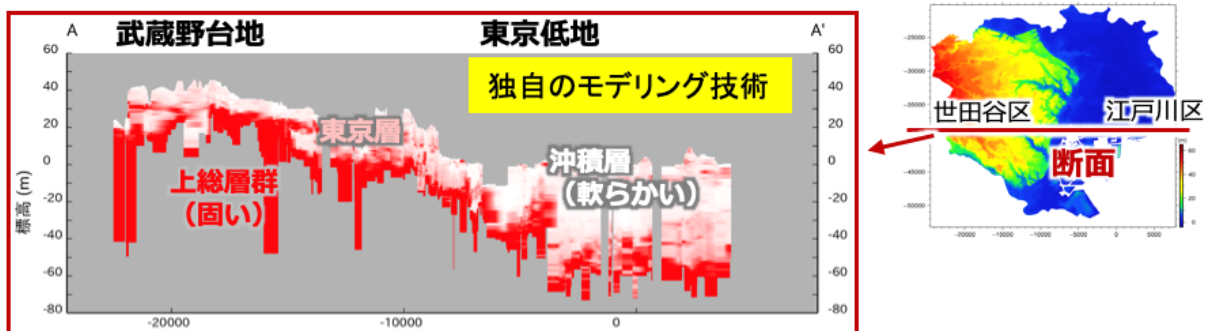
図Ⅲ-8. 地層の固さ軟らかさを示すN値分布3次元地質モデルの断面図の例
