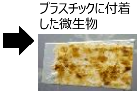
海洋での生分解性プラスチック浸漬実験
