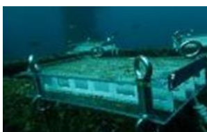
海洋での生分解性プラスチック浸漬実験
