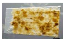
海洋での生分解性プラスチック浸漬実験
