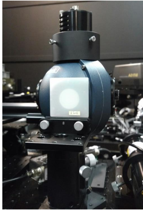
图. 分光透過率測定装置
