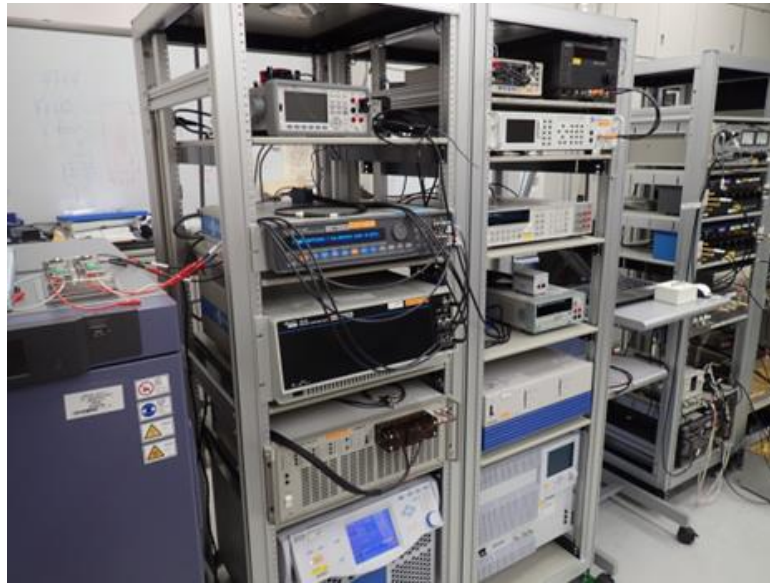
図. 蓄電池性能評価装置
