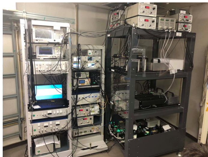
図. 分光器校正用光周波数コム装置
