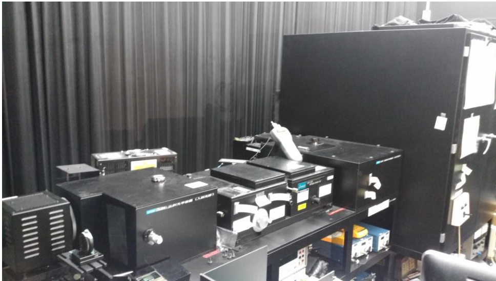
图. 分光応答度比較校正装置
