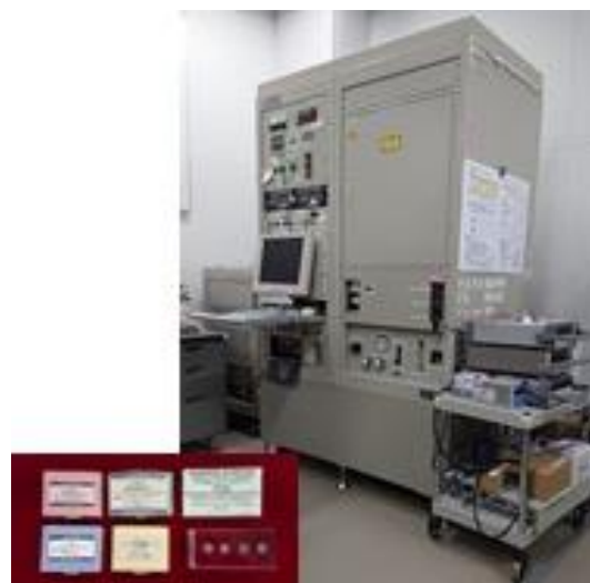
図. レーザーフラッシュ法による熱拡散率測定装置
