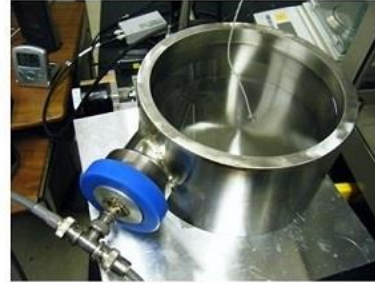
図. 天秤法（左）、カロリメトリ法（右）による超音波パワー校正装置
