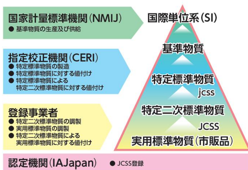
図. JCSSにおける標準物質の供給体制・SIへのトレーサビリティ体系
