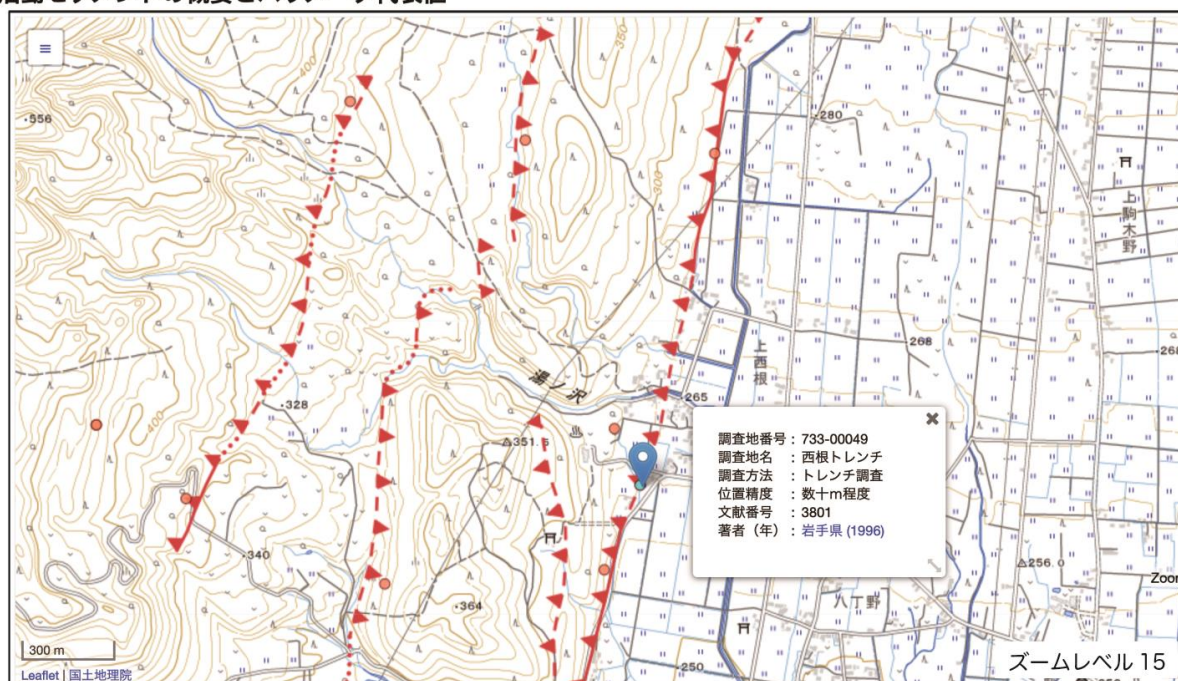
図3-5: データ位置精度改善及び表示システム改良後の活断層データベース表示画面拡大表示後も活断層線と調査地が適切な位置に示されるほか、活断層の特性や調査地の属性情報を簡単に認識することが可能となる。
