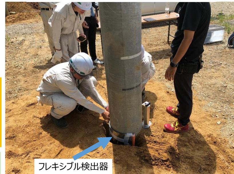
欠陥が生じやすい地表付近の構造検査を可能にする3次元X線システム
