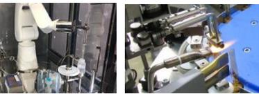
自動段階希釈装置(ロボットブース内部イメージ) アンプル自動熔封設備(熔封装置イメージ)
