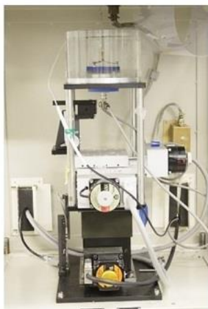
図. 天秤法（左）、カロリメトリ法（右）による超音波パワー校正装置
