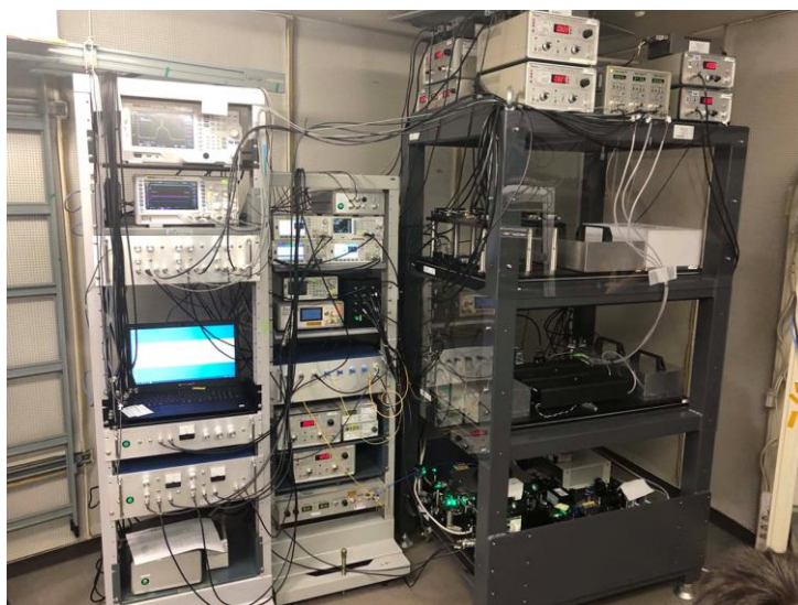
図. 分光器校正用光周波数コム装置
