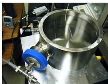
図. 天秤法（左）、カロリメトリ法（右）による超音波パワー校正装置
