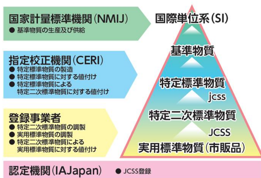
図. JCSS における標準物質の供給体制・SI へのトレーサビリティ体系
