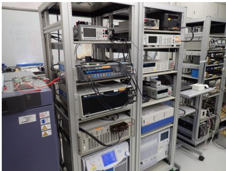
図. 蓄電池性能評価装置
