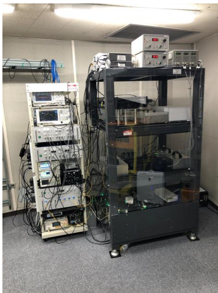
図. 国立天文台に設置されている分光器校正用光周波数コム装置
