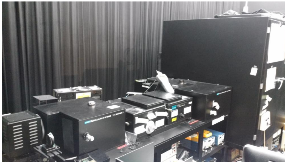
図. 分光応答度比較校正装置
