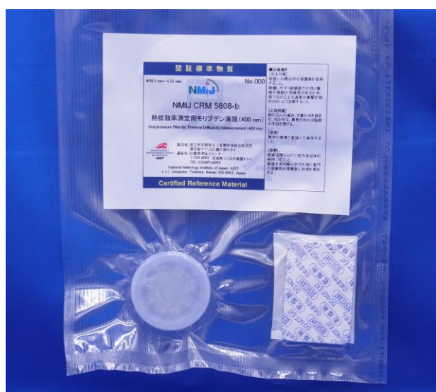
図. 熱伝導率測定用金属薄膜標準物質
