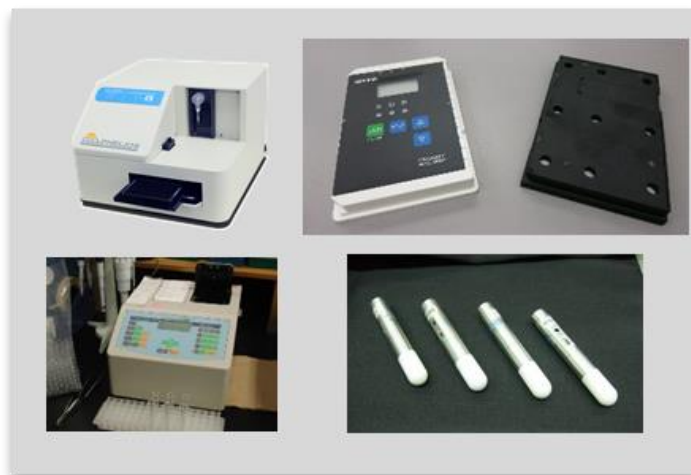
図. 発光測定装置（左）と、その精度管理のための参照用光源として使用される極微弱 LED 光源（右上：プレートタイプ、右下、チューブタイプ）
