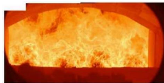
都市ガス専焼窯の燃焼状況
