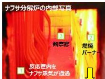
約850°Cでナフサ熱分解している炉の熱源をアンモニアに転換
