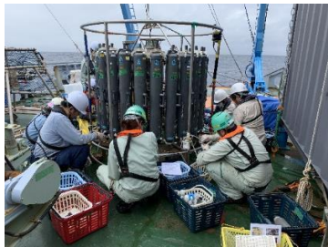
海洋調査、海域環境調査の様子 (左：海水サンプリング、右：海底堆積物採取)
