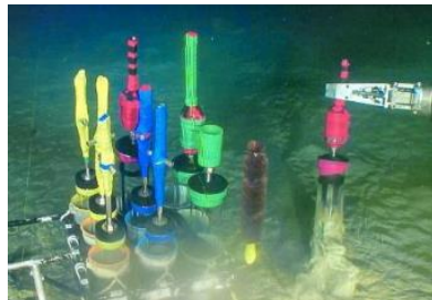
海洋調査、海域環境調査の様子 (左：海水サンプリング、右：海底堆積物採取)
