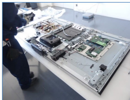
液晶式テレビ(2014年モデル) ネジ本数 : 236本 基板数 : 5枚
