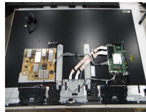
液晶式テレビ(2017年モデル) ネジ本数 : 80本 基板数 : 3枚
