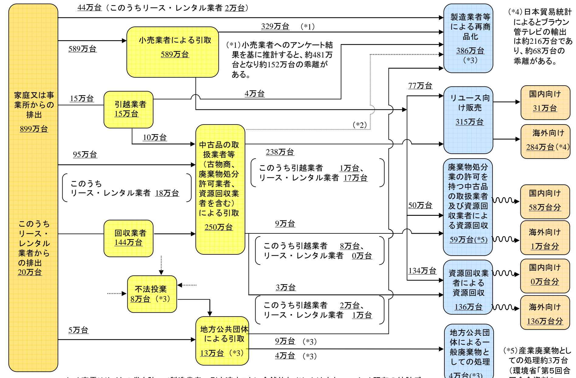
(4) 冷蔵庫・冷凍庫の排出・引取・再商品化等のフロー推計図
