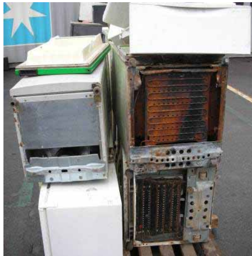
【扉が外れ、底面が焼け焦げている冷蔵庫】
