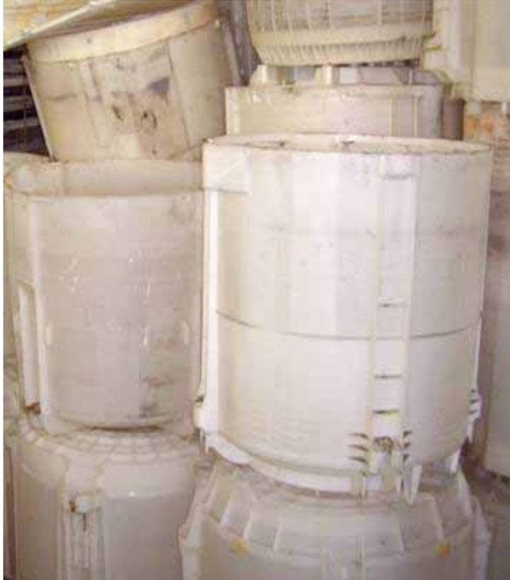
写真 洗濯槽(外槽)
