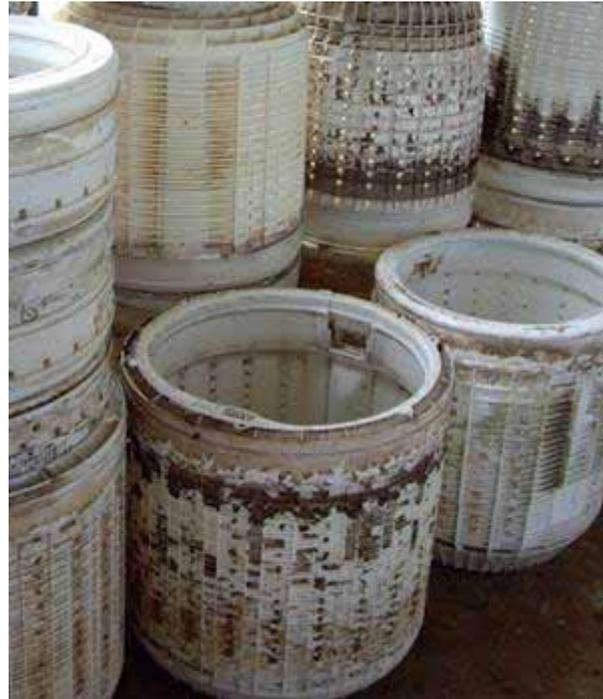
写真 洗濯・脱水槽(内槽)
