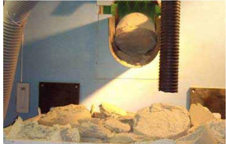
写真 断熱材(断熱材ウレタンを円筒形に圧縮した写真)
