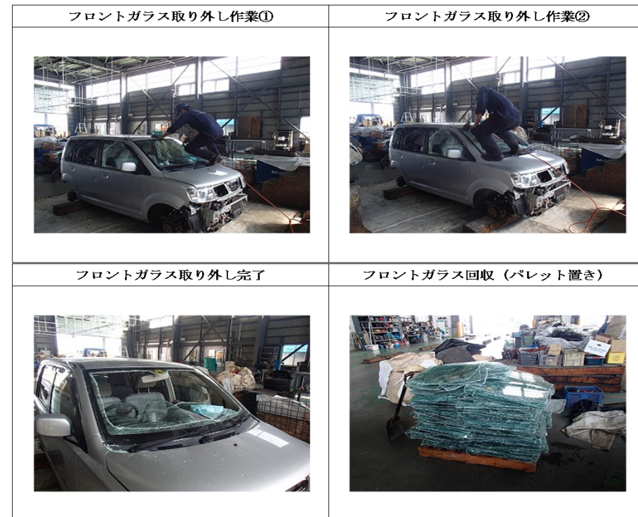
図 フロントガラスの取り外し状況
