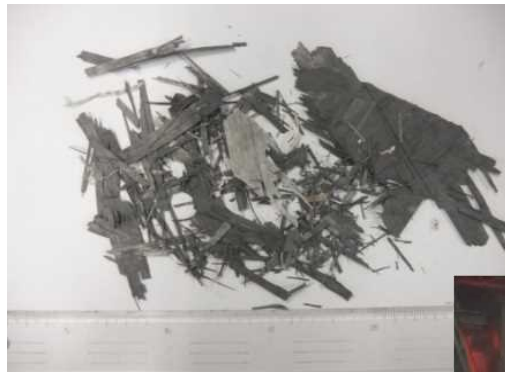
破碎後の水素タンク
