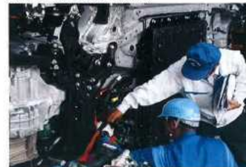
〈水素タンクくず化・ドリル穴あけ作業〉
