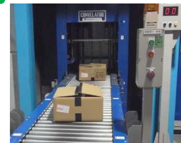
焼却炉への投入(一例)
