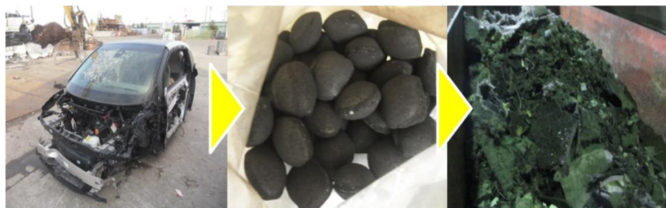
車台をシュレッダーに投入 CF含有ASRを炭化炉に投入し、生成したブリケット ブリケットを電炉に投入
