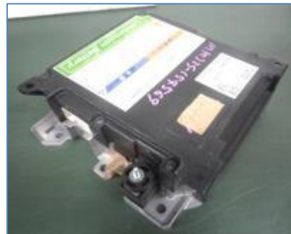
図3-2 電池パック サイズ: 232 × 200 × 75mm 重さ: 2.5kg
