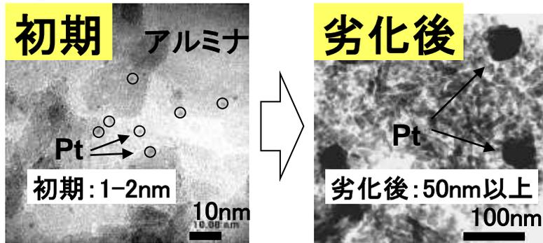
貴金属の粒成長を抑制し使用量削減を推進
