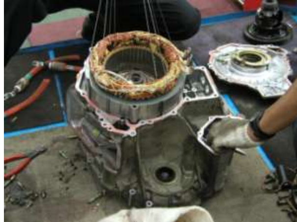
モーター取外し作業(コイル部)
