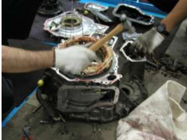
モーター取外し作業(コイル部)
