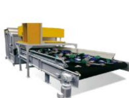
廃プラの選別設備
