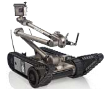
例4: マルチミッションロボット (出典) PackBot公式サイト
