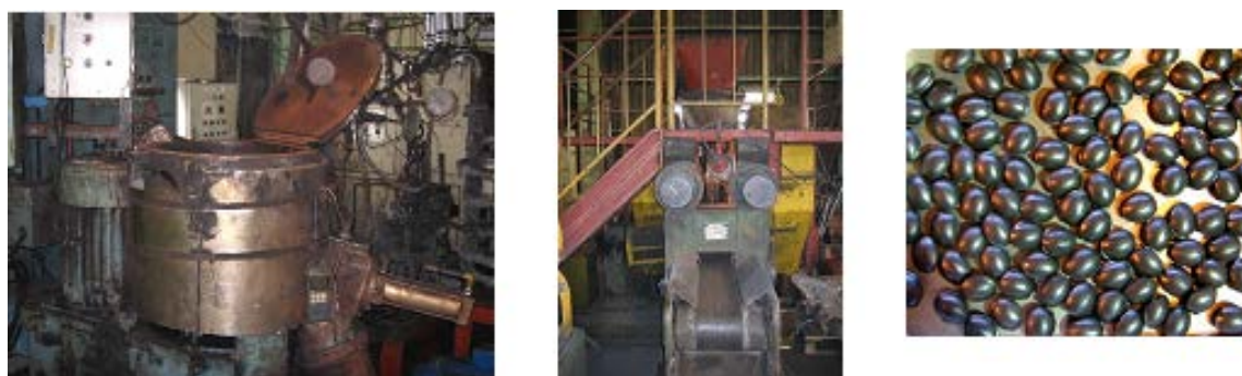
図 3-1 攪拌機・成型機および成型物（約 6cc）
