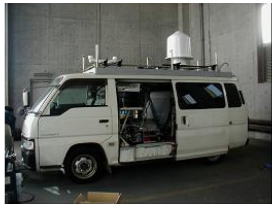
受信アンテナと信号処理装置
