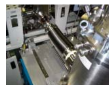
VCS-F1031超電導計測機器用極低温クライオスタット
