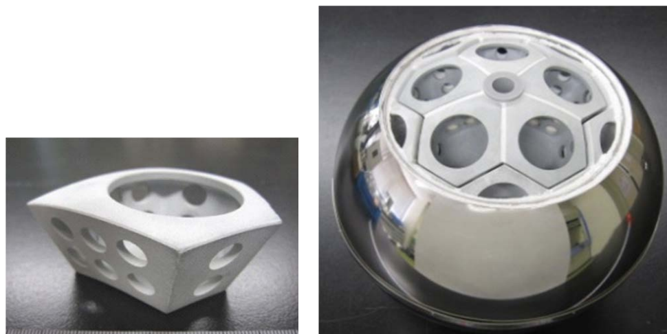
図3-3 中空ユニット、及びアッセンブリーの外観（RBSN製、1/4スケールモデル）
