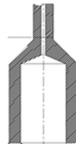
図 8 エアパーージ式液位計先端
