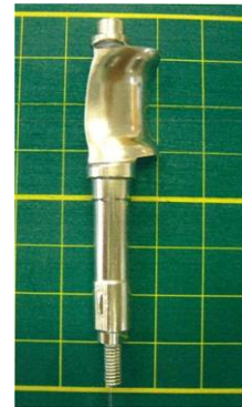
圧縮機可変静翼（単翼）の試作例
