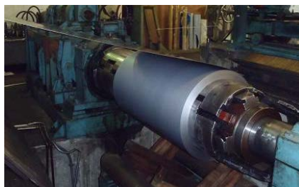
図 3-3 工場生産ラインで試作した KS Ti-9 コイルの外観
