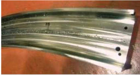
図 3-16 模擬部材(型材溶接後)
