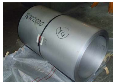
図 3-3 工場生産ラインで試作した KS Ti-9 コイルの外観
