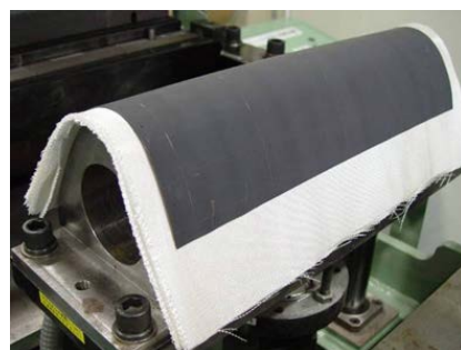
図 3-5 複曲面形状の試作部品
