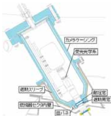
図(3)-3 高圧化可視化計測装置
