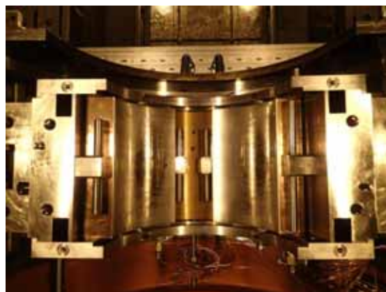
図(8)-3 試験後の軸受開放検査結果
