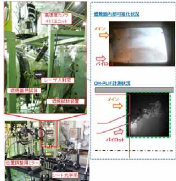
図(3)-5 実燃焼器でのレーザーによる火炎計測状況 ( I.I : Image Intensifier )
