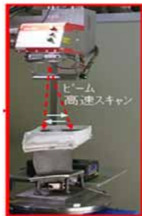
(a) リモート光学系による低入熱溶接工法例 (b) 変形抑制効果の例
