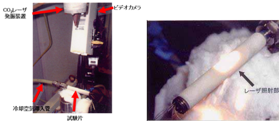
図(1)-4 レーザー熱サイクル試験
