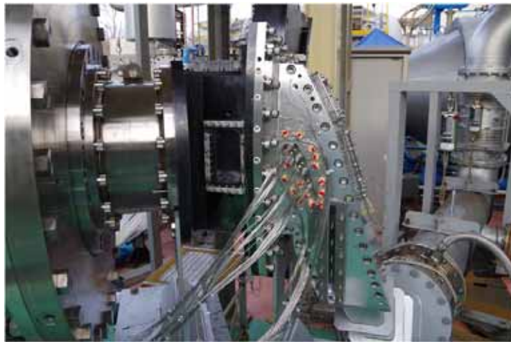
図(2)-1 燃焼器-タービン第一段静翼で構成される、燃焼ガス流れ詳細計測試験装置
