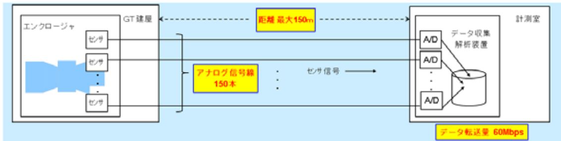
図(12-3)-1 現状の振動応力計測通信系
