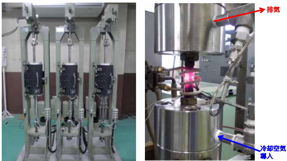
図(10)-3 実翼模擬中空冷却クリープ試験装置概要
