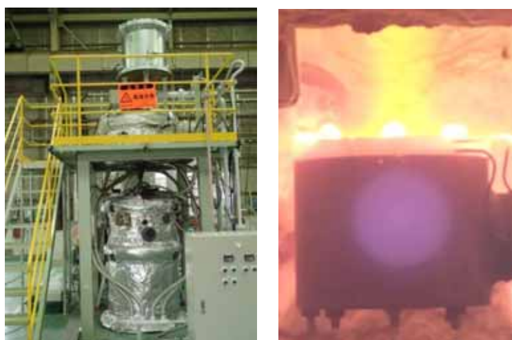
図(1)-5 高温エロージョン試験
