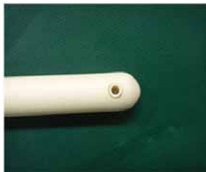
図(11-1)-3 ファイバー式ガス温度計測プローブ
