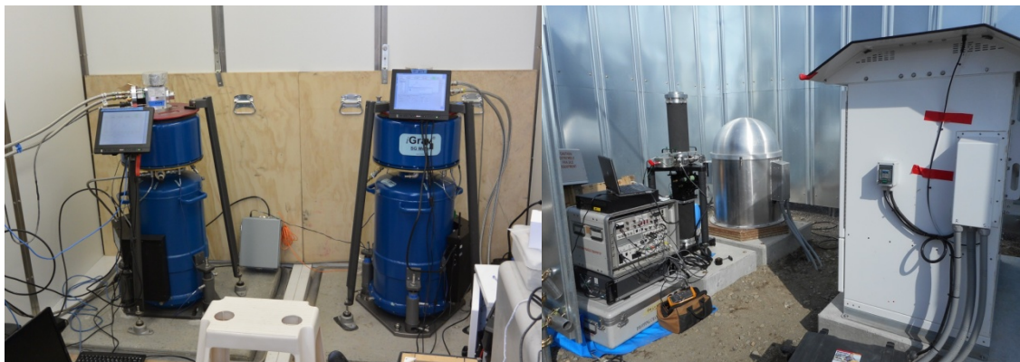
図 3.I.2-34 米国 FWU テストサイト AWT3 における 2 台の超伝導重力計 iGrav015 と iGrav017 による並行測定（左）と苫小牧サイトにおけるエンクロージャに納めた超伝導重力計と絶対重力計の並行測定（右）。
