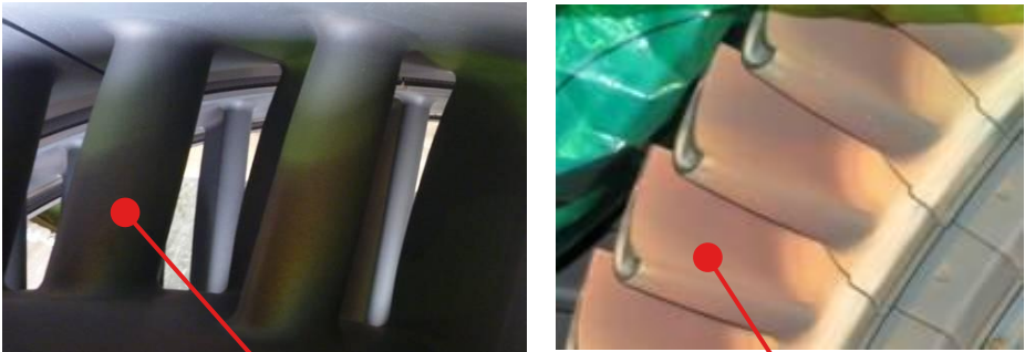
図 タービン側内部(静翼・動翼)
