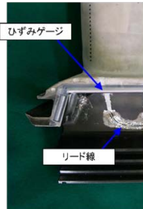
溶射ゲージの施工例
