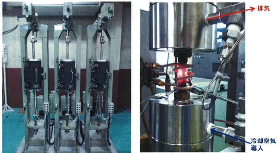
図(10)-3 実翼模擬中空冷却クリープ試験装置概要
