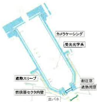
図(3)-3 高圧化可視化計測装置
