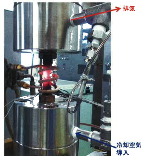
実環境を模擬した中空冷却クリープ試験装置
