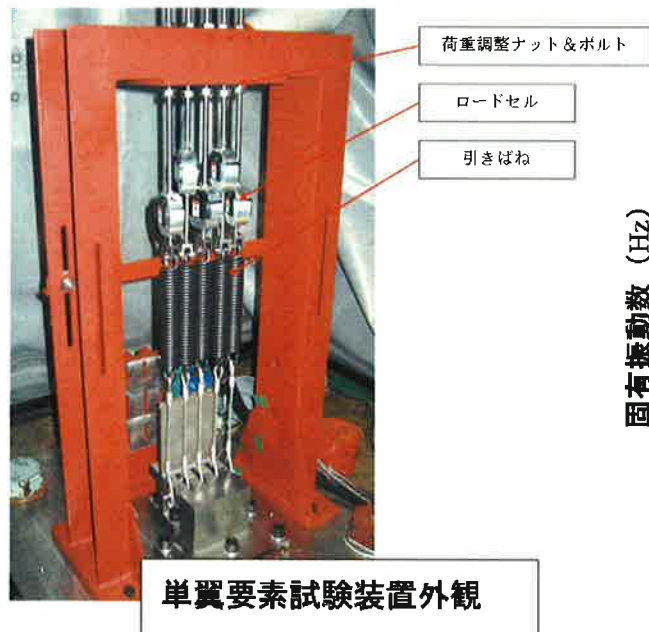
[1]-1 単翼ダンパ要素試験装置
