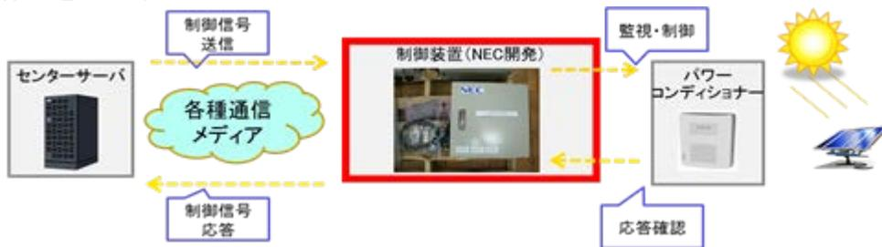
図3-5-2. 通信アダプタシステム構成
