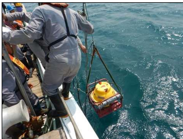
図 3-53 OBS本体の設置作業
