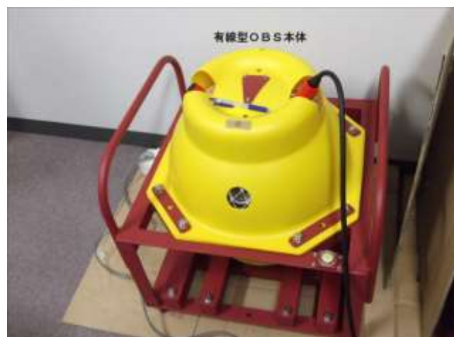
図 3-49 有線型OBS本体の外観写真
