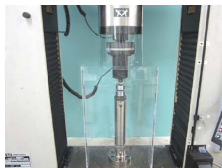
圧壊強度確認試験
