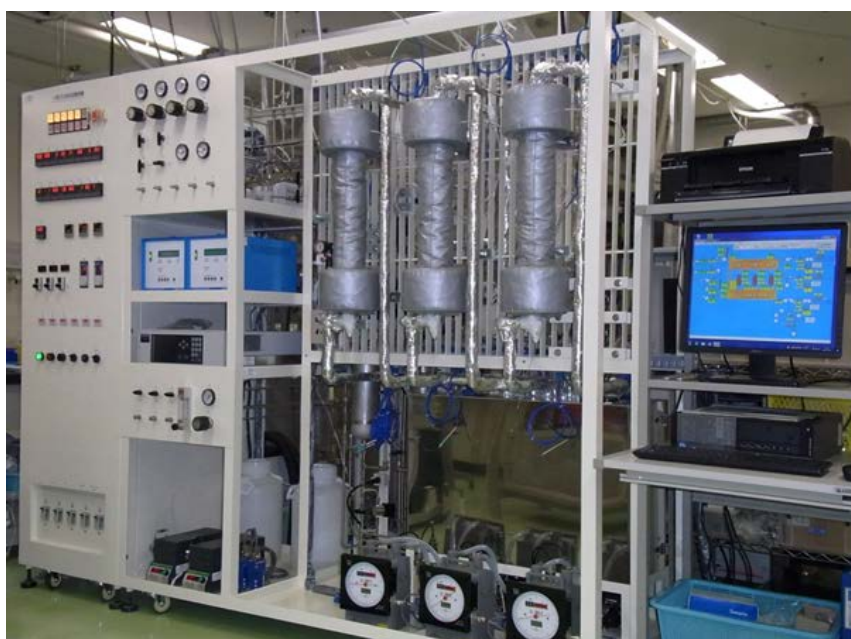
図 3-20 CO 2 小型連続回収試験装置
