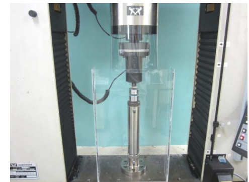
圧壊強度確認試験
