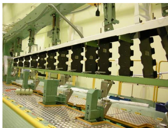
図３－１１． 工作試験の様子（SPAR と RIB の組み付け検証）
