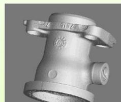
自動車クラッチの部品の三次元寸法計測
