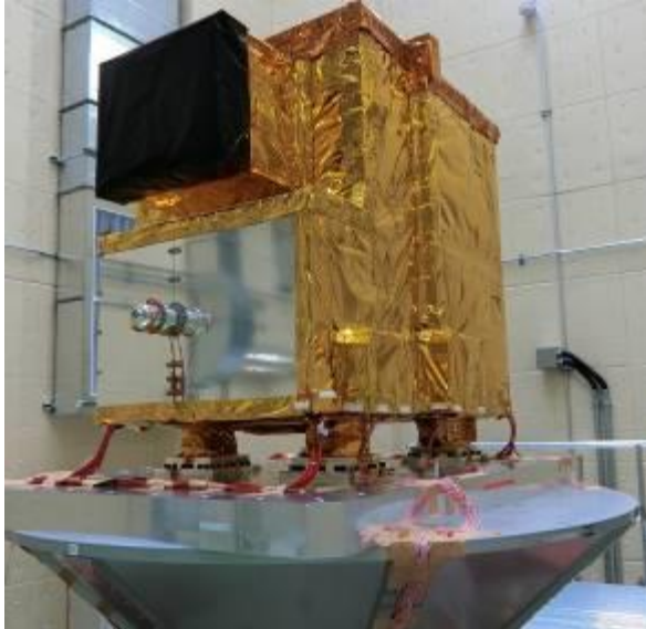
図 2-A-4 振動試験セットアップ状況
