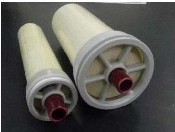
① 膜エレメント (左 2inch、右 4inch、L200mm)
