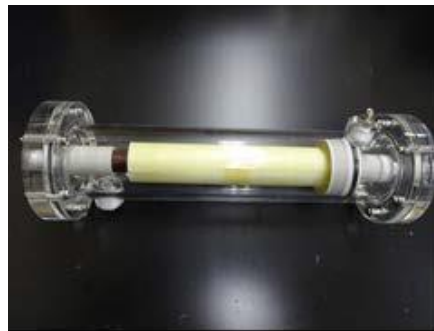
② ハウジング中に組み込んだ膜エレメントのイメージ (透明なアクリル製ハウジングを使用)
