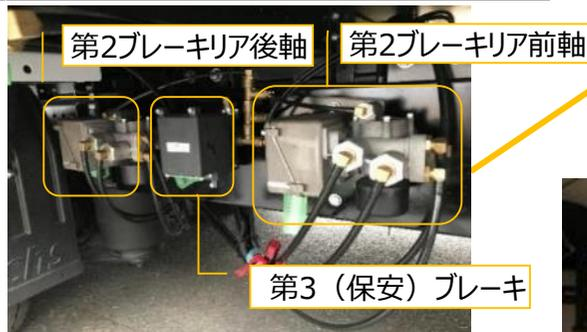
自動制動装置の多重化
