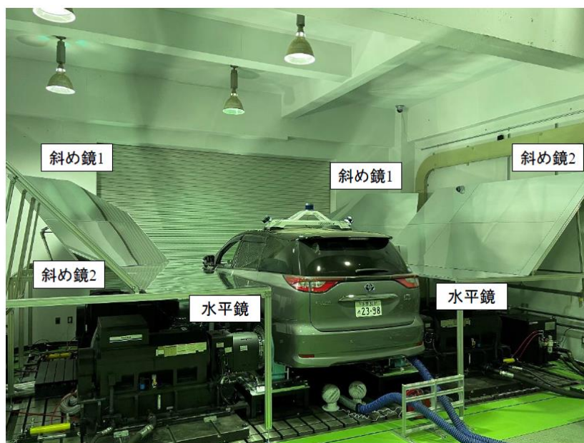
試験設備に設置した鏡架台
