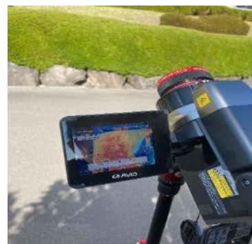
赤外線汎用機（地上設置）による熱画像の撮影
