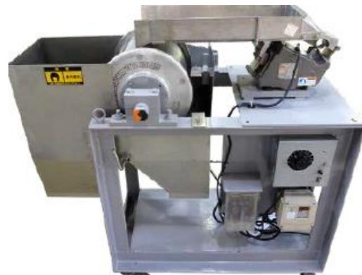
図 11 レアアースドラム磁選機
