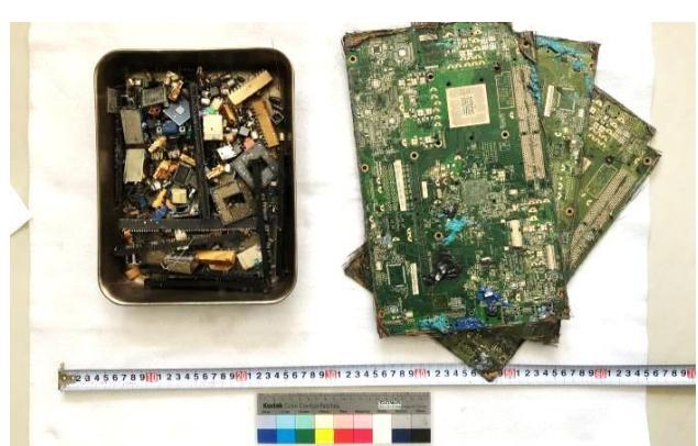
図5 加熱後の基板および剥離した素子類
