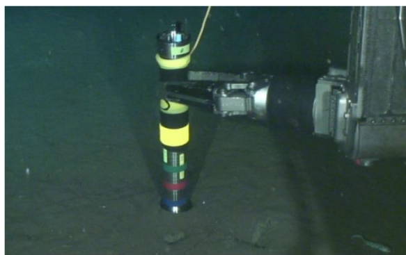
地中温度計の設置
